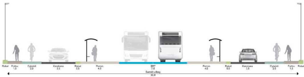
Figur 17 Tværsnit på Usseørd Kongevej nord for eksisterende rundkørsel ved Ådalsvej med midterlagt BRT-tracé og BRT-station.
